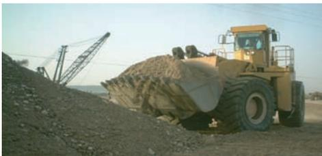
Pala cargadora en operación de carga del todo-uno en el frente.
