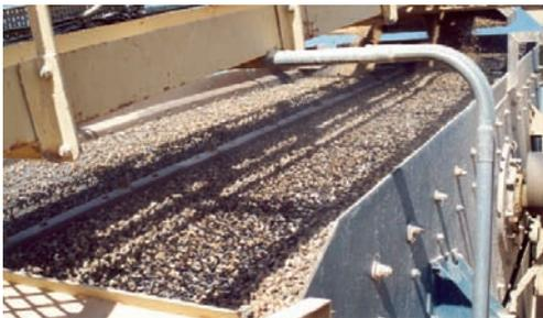
Mediante los sistemas de criba se seleccionan los diferentes tamaños de los áridos para su posterior comercialización según su uso.
