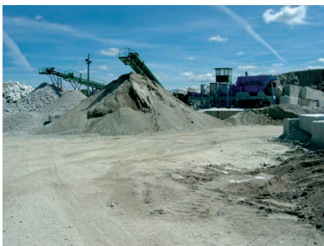
Tratamiento de estériles para la fabricación de áridos en una explotación de granito ornamental.
