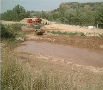
Balsa de lodos. Los sólidos se depositan y las aguas claras retornan al circuito de lavado de arenas. El lodo seco se retira con pala cargadora y se lleva, en camiones, a las áreas a restaurar. (71)
