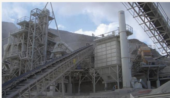
Sistema de captación de polvo en la planta de trituración: reducción del polvo y el impacto visual producido por éste en la molienda de la instalación. (6)
