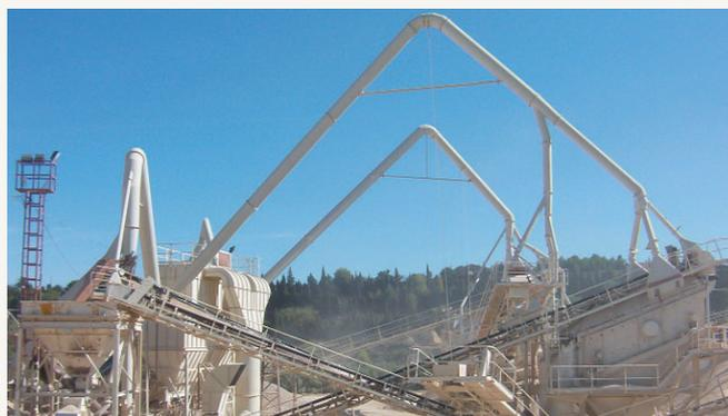
Sistema de eliminación de polvo por vía seca, mediante un sistema de aspiración en todo el circuito de trituración secundaria, formado por un filtro de 630 mangas, una turbina, un compresor, y un silo de almacenamiento del polvo aspirado durante el proceso de molienda. (8)
