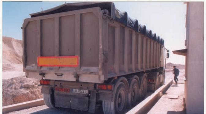
Caja de camión cubierta con lona. Reducción la emisión de polvo en el transporte y posible caída de áridos a la vía pública
