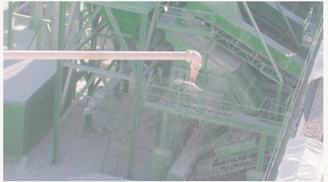
Aspersores en distintos puntos del proceso como en la tolva de descarga, cintas, descensores, molinos... (13)
