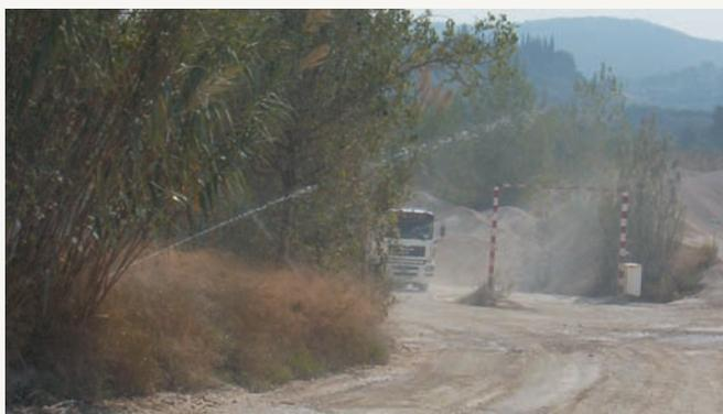
Sistema de riego mediante aspersión en todos los accesos a la instalación de áridos y zonas de carga de la planta de trituración, dividido en cuatro sectores que funcionan alternativamente, para evitar encharcamientos de las pistas. (9)
