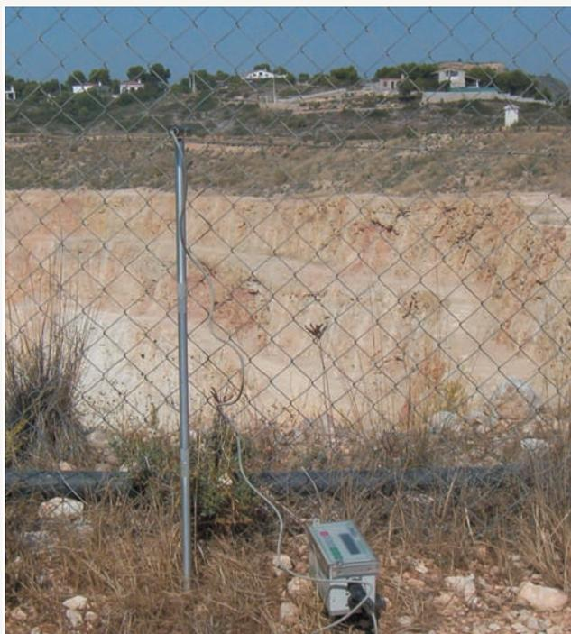
Control de vibraciones en el entorno de la explotación para estudiar la relación carga vibración con objeto de calcular la carga instantánea en la voladura siguiente. (5)
