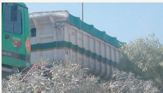
Instalación de lonas de accionamiento manual mediante polea en los camiones bañera. (42)
