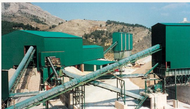
Planta carenada y cintas cubiertas. Limpieza intensiva periódica. Suelos totalmente despejados de vertidos de material. (62)
