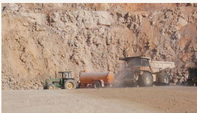
Riego continuado de las pistas y zonas de acopio mediante tractor con una cuba y sistema de difusión en abanico. (11); (17)
