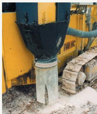
Perforación de barrenos con sistema de aspiración del polvo
