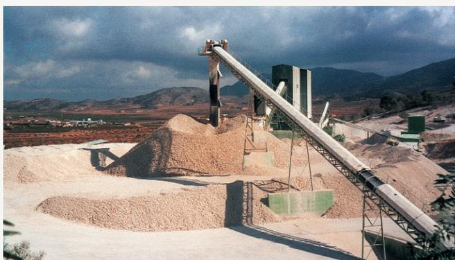
Tubo descendedor en acopio de finos. Evita la acción del viento en la caída del material. (55)
