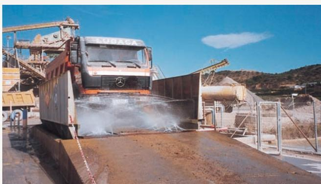
Sistema de lavado de ruedas y bajos del camión por agua a presión. (81)
