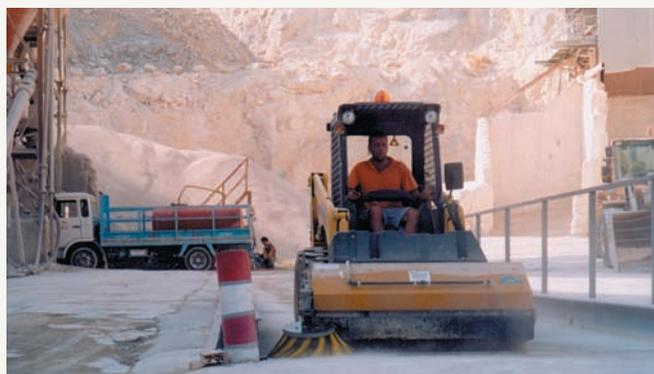
Mini pala barrendera con depósito de agua: evita la acumulación de polvo y permite tener limpias las instalaciones. (23)
