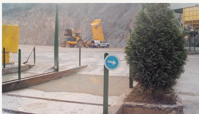
Arco de riego de la carga y piscina de recogida y lavado de ruedas. (82)
