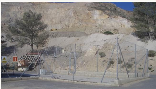
Zona de repostaje con sistema de recogida de derrames de aceites e hidrocarburos y asfaltada para proteger, asimismo, el suelo de la posible contaminación. (26)
