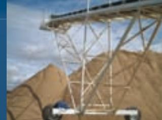
El movimiento de los áridos entre los distintos equipos de la planta de tratamiento se realiza a través de un sistema de **cintas transportadoras**
