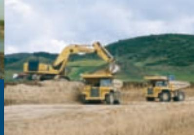
*Transporte a la planta de tratamiento mediante camiones, dumpers o cintas transportadoras*
